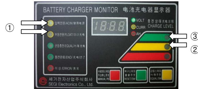
\* 1~2회 반복 후 충전상태 황색등이 점등되면 자동·수동 절체 스위치를 필히 자동으로 절체 후 충전기가 자동으로 TRIP 되는지 확인합니다.
